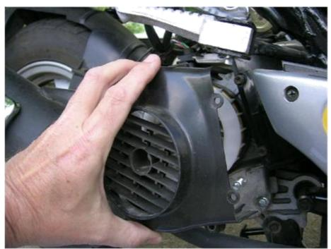
Fig. 2. Remove fan cover
