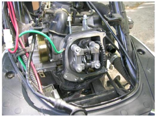
Fig. 6. Remove camshaft caps (before)
