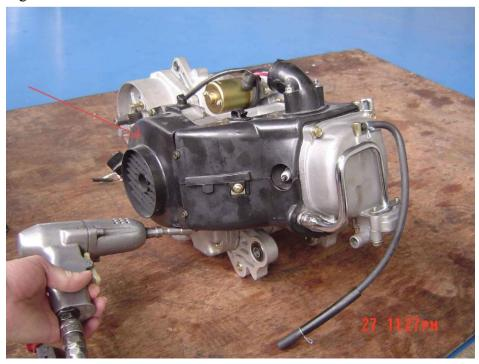
Fig. 17. Install fan cover, wires etc.
