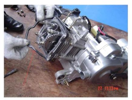
Fig. 14. Install gasket
