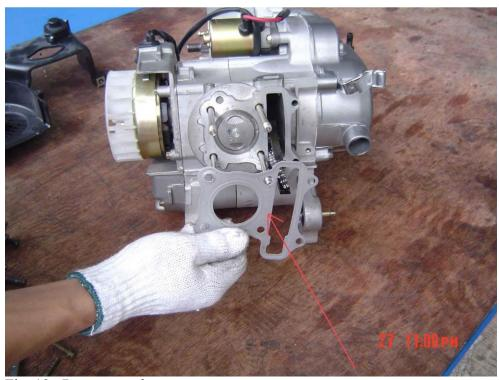
Fig. 12. Remove gasket
