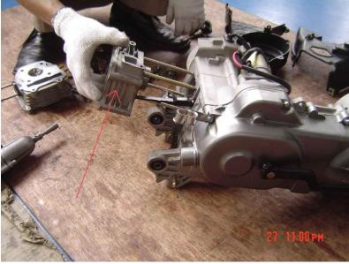
Fig. 14. Remove cylinder.
